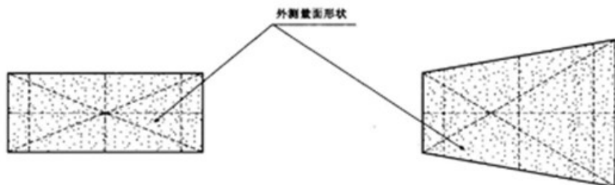
图 B.1 划线量爪工作面平面度的检验方法
